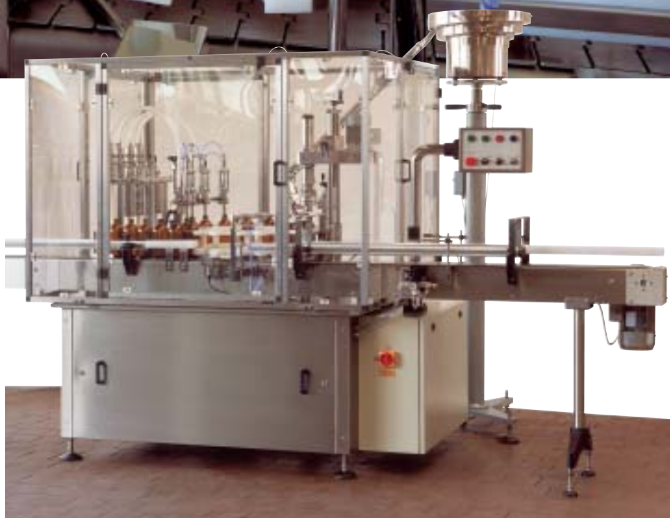
Spektrum 4/2. Monoblok do napełniania i zamykania butelek.
